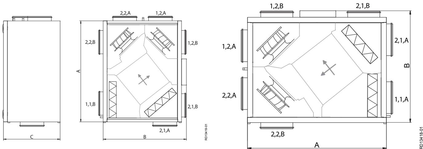
Maßskizzen für VEX100V = vertikale Version (obere Abbildung) und VEX100H = horizontale Version (untere Abbildung), beide mit runden Rohrleitungen dargestellt.
