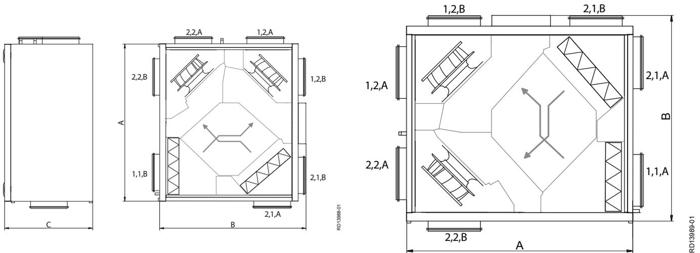
Maßskizzen für VEX100CFV = vertikale Version (obere Abbildung) und VEX100CFH = horizontale Version (untere Abbildung), beide mit runden Rohrleitungen dargestellt.
