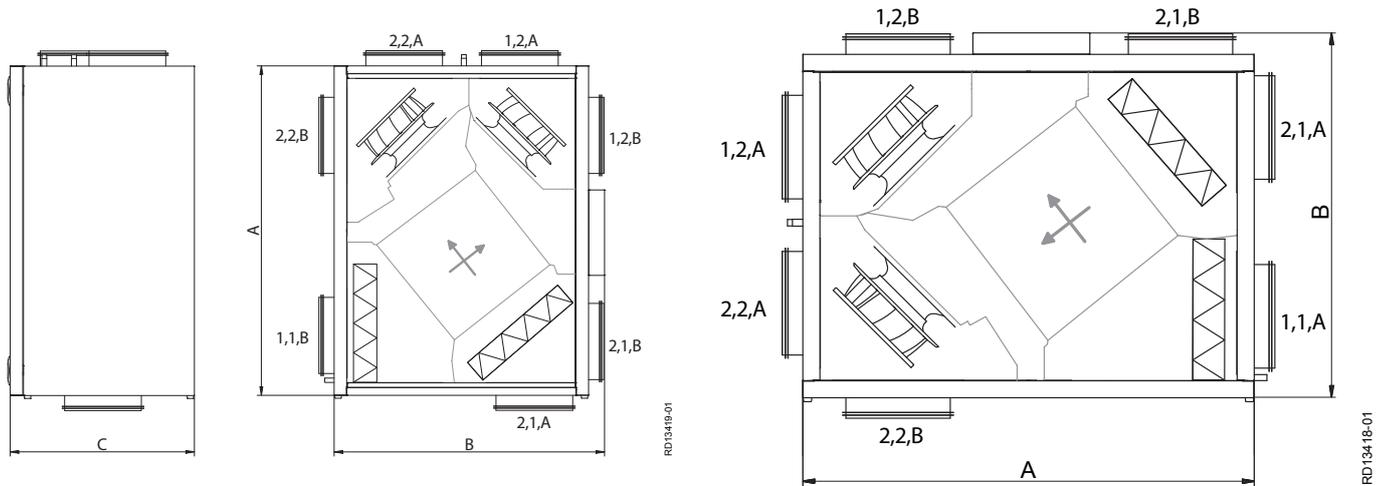
Maßskizzen für VEX100V = vertikale Version (obere Abbildung) und VEX100H = horizontale Version (untere Abbildung), beide mit beiden Konfigurationen dargestellt.
