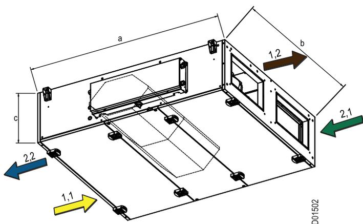
1,1 = Abluft • 1,2 = Eortluft • 2,1 = Außenluft • 2,2 = Zuluft
