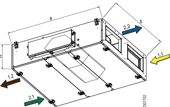
1,1 = Abluft / 1,2 = Fortluft / 2,1 = Außenluft / 2,2 = Zuluft
