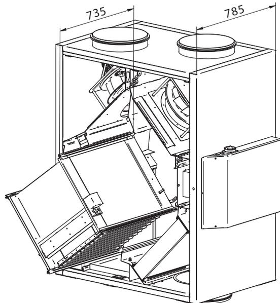
**Hinweis** Zwecks Wartung des VEX-Geräts ist eine lichte Höhe von mindestens 300 mm über dem Anschlusskasten erforderlich.
