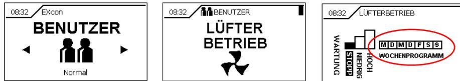
Einstellungen am Handterminal zur Ausführung von Start/Stop an der LON-Einheit
