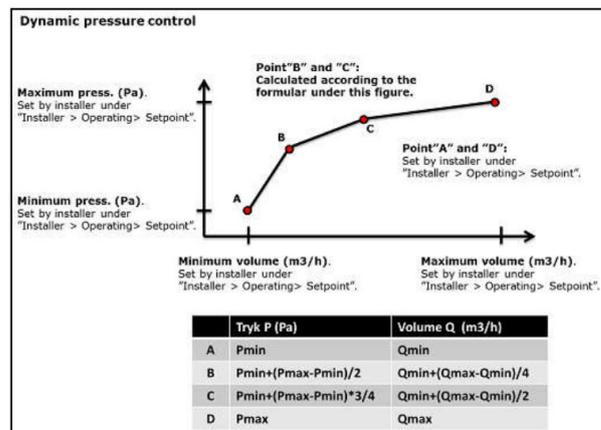
Für die Ventilatorregelung „Dynamischer Druck (aDCV)“ ohne modulierte Umluft gilt:
