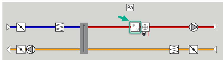
Die DX-Kühlung und die RHP-Wärmepumpe (Reversible Heat Pump) sind mit einem oder zwei Verdichtern ausgestattet. Stufe 1 ist immer modulierend und evtl. Stufe 2 ist fest. Im Kühlkreis müssen Druckmessumformer zur Messung von Hochdruck und Niederdruck im DX-Druckkreis montiert werden.
