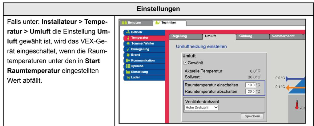
Falls unter: **Installateur > Temperatur > Umluft** die Einstellung **Umluft** gewählt ist, wird das VEX-Gerät eingeschaltet, wenn die Raumtemperaturen unter den in **Start Raumtemperatur** eingestellten Wert abfällt.
