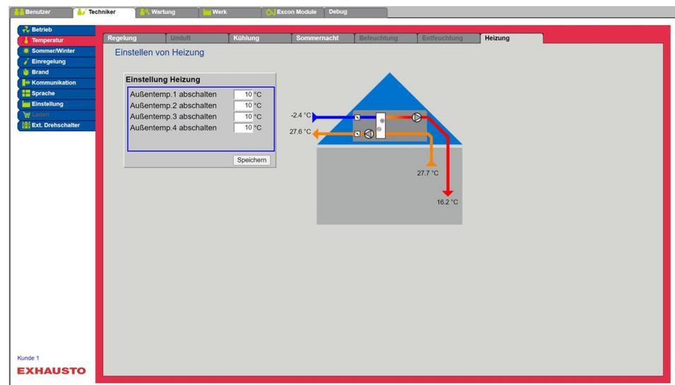
Wenn die Wärmepumpe (RHP) als Wärmeerzeugung für die Anlage in Betrieb ist, laufen die Kompressoren als Wärmepumpe und liefern die in die Zuluft eingespeiste Wärme.
